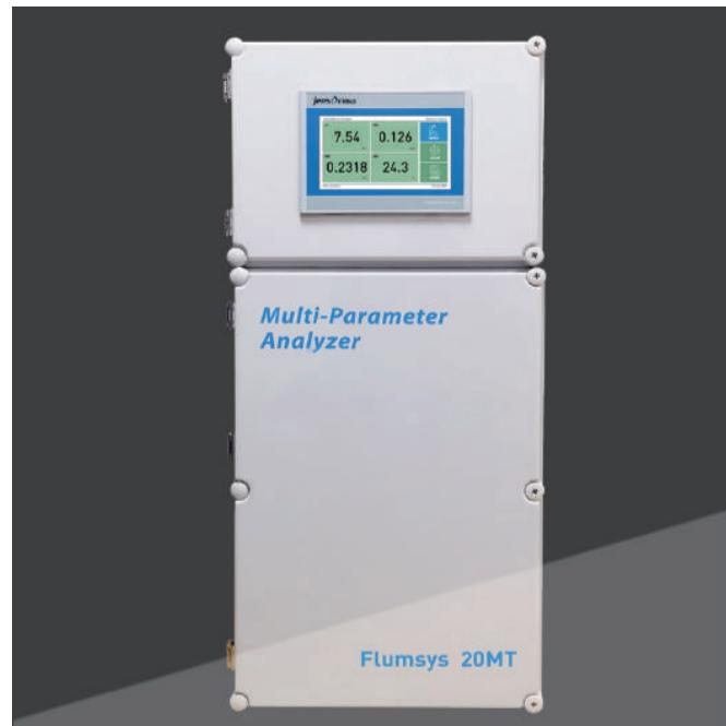
Flumsys 20MT在线分析仪专为管网水质监测、二次供水水质监测和农饮水水质监测而设计,一体化集成,可同时测量显示多个参数,具有数据存储、数据传输等功能。中文操作界面,操作简单,可对传感器进行快速设置和校准。该款分析仪采用高精度浊度模块,内置消泡结构,测量更加稳定精确。余氯模块可选DPD试剂比色法或恒电压电极法,满足客户不同的应用需求。
