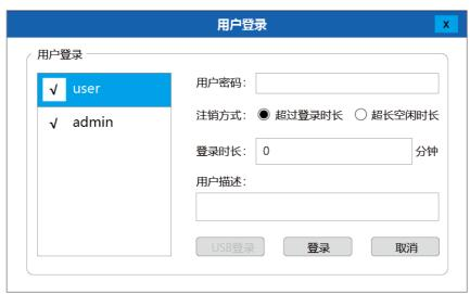
选择user,输入用户密码: 0022,点击"登录"按钮进入系统设置菜单。系统设置菜单子菜单有:常规设置、输出设置、工艺设置、关于杰普,通过触碰按钮即可相互切换。
